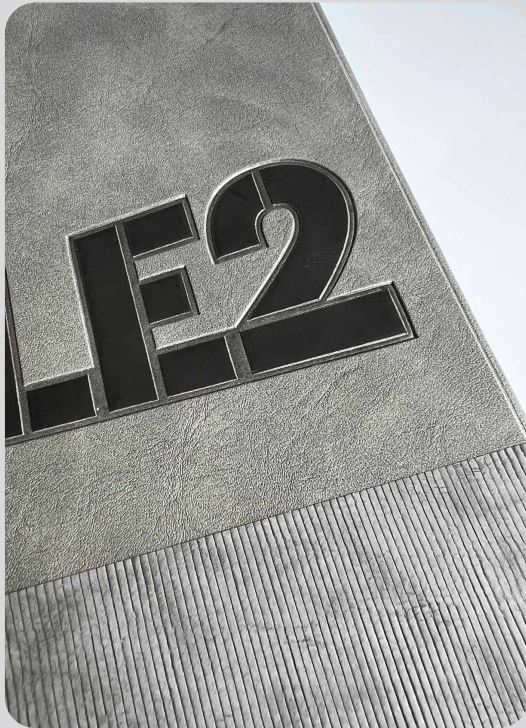
Совмещение блинтового тиснения с линиями специальной фольги
